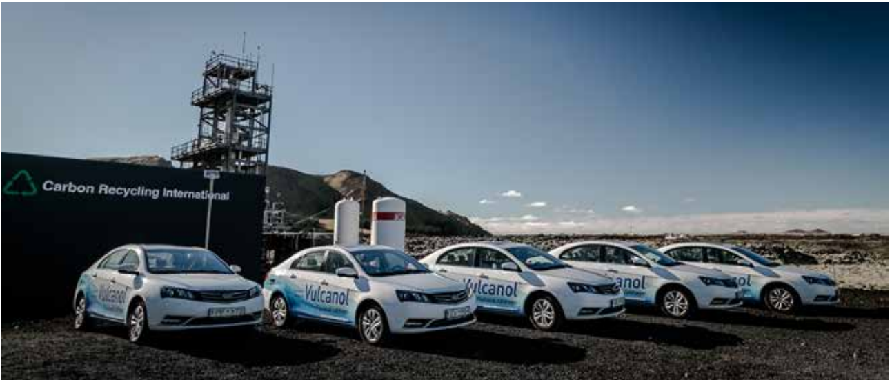
图 44. 采用 M56 混合燃料的瑞典汽车（汽油中含有 56% 的甲醇），所用生物甲醇来自 LTU 绿色燃料厂（背景）
