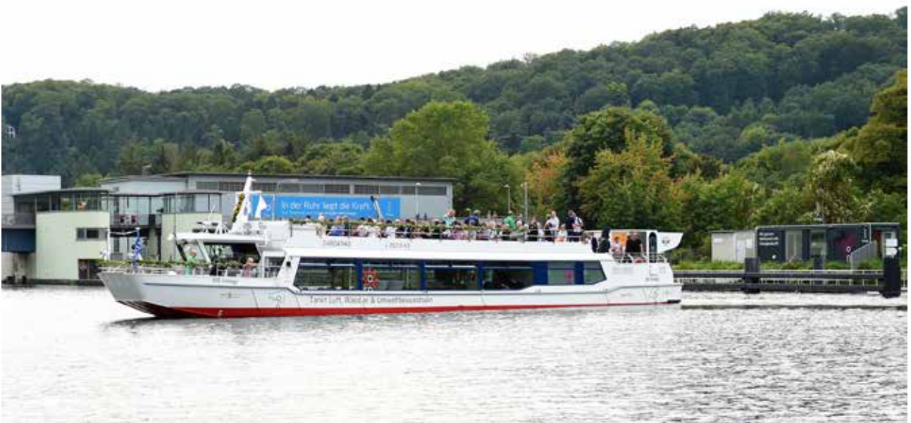
图 46. 德国巴尔登尼湖上由可再生甲醇混合燃料电池系统驱动的 MS innogy 号客轮
