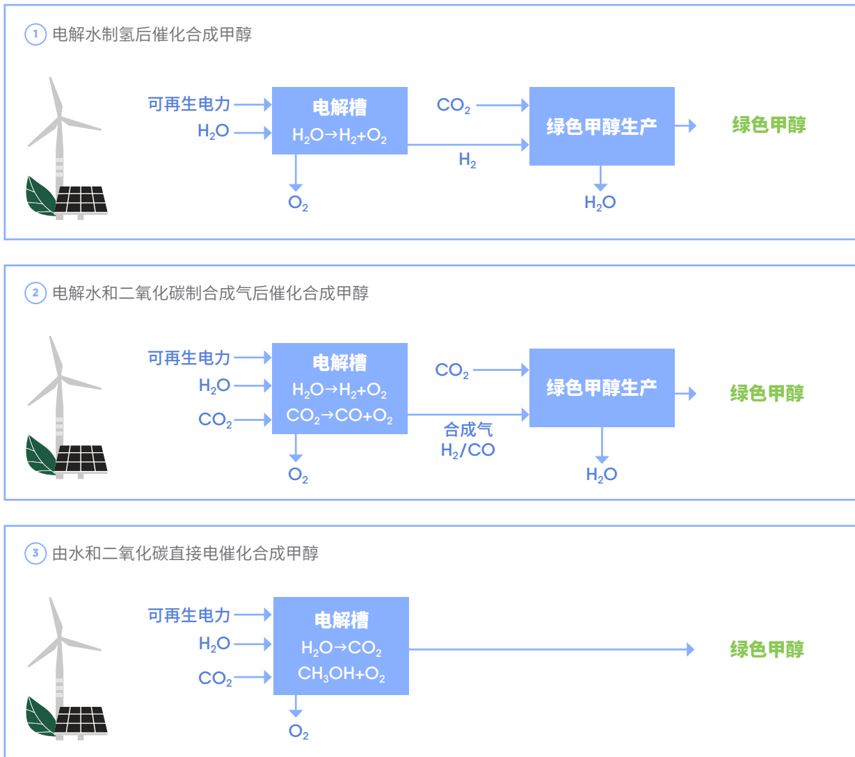
图 24. 通过电解和电化学工艺生产绿色甲醇的方法
